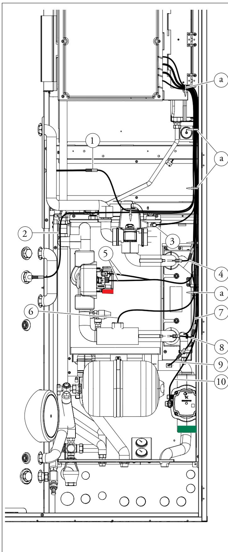
Una volta effettuato l'assemblaggio del kit procedere al cablaggio secondo quanto rappresentato nella figura a lato.
