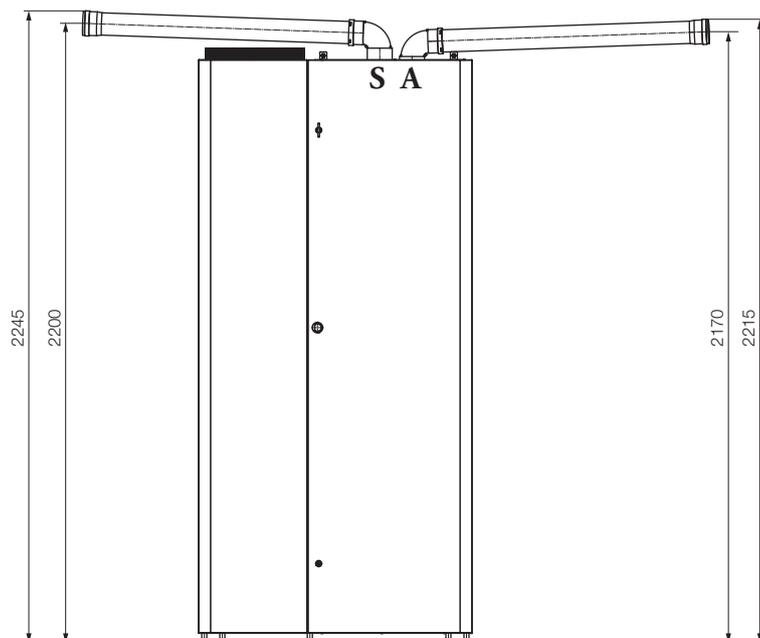
**NOTA:** Le quote sono riferite all'installazione del generatore a condensazione previsto per TRIO PACK HYBRID
